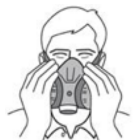
Vérification de l'étanchéité à la pression à vide
