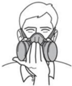
Vérification de l'étanchéité à la surpression
